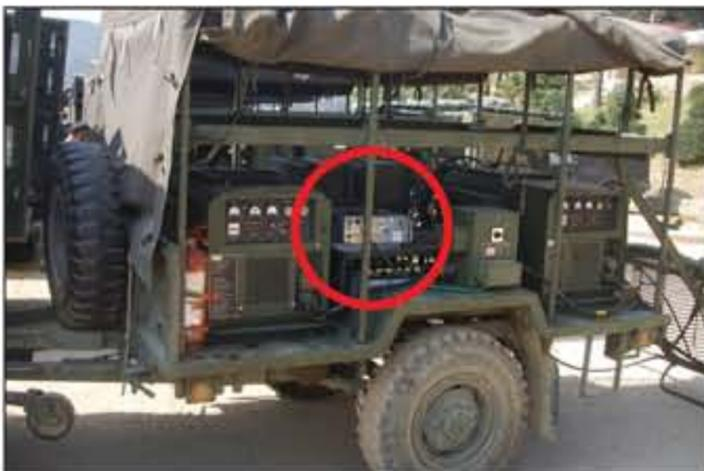
그림-11. 지원차량(발전기)에 3세대 접지장치(eca3G) LM Series 설치(2008.12)
