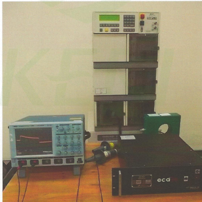
Photo. SG02 : 서지제한전압측정 및 동작책무시험
