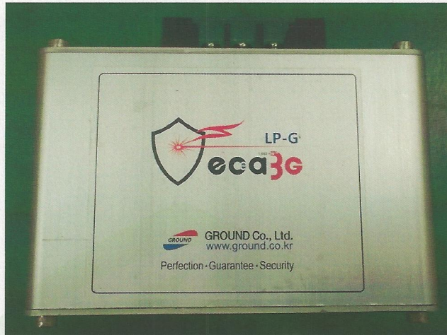
제품명 : 저압 서지보호장치 형식명 : LP-G 정격전압 : AC 250 V
