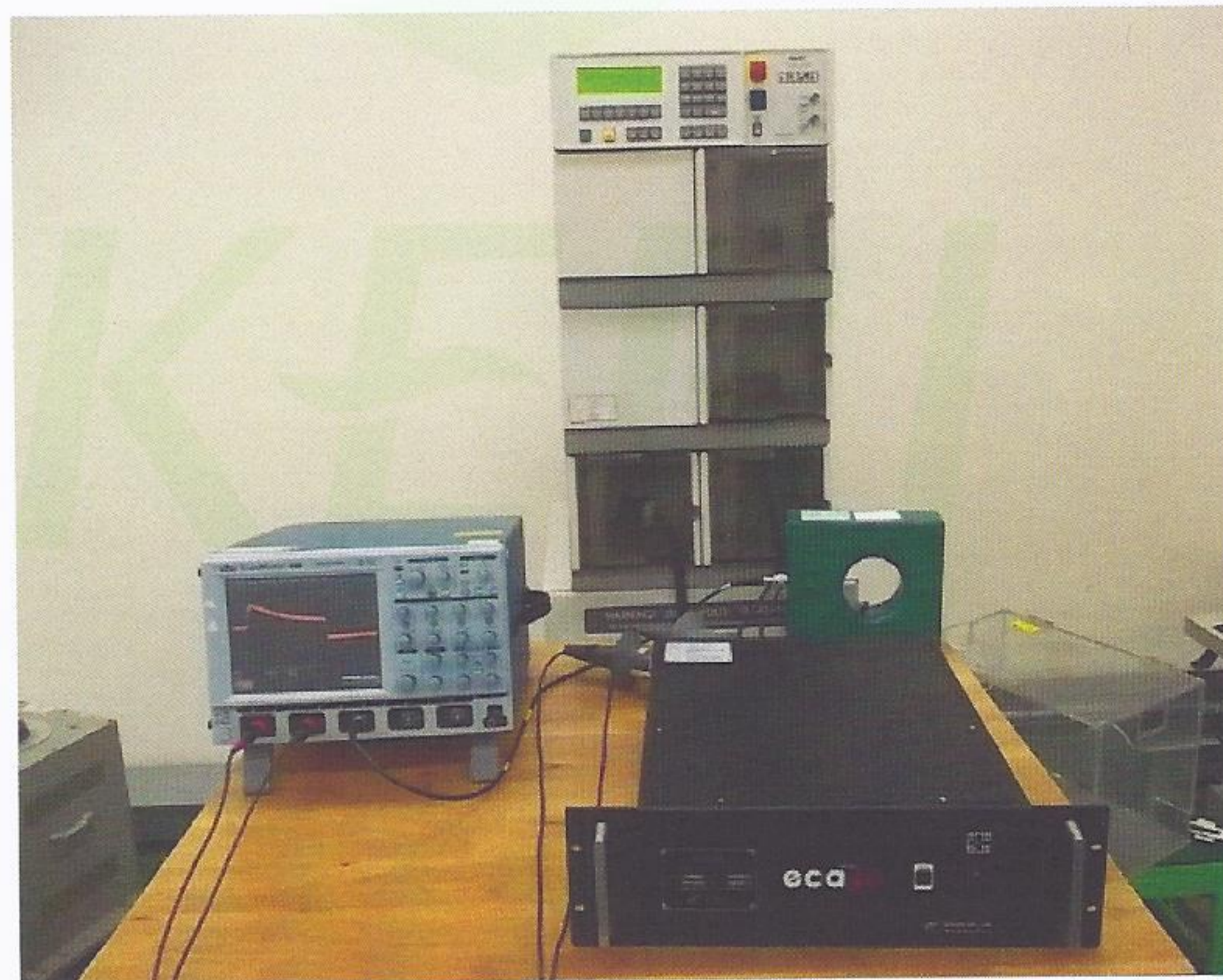
Photo. SG02 : 서지제한전압측정 및 동작책무시험
