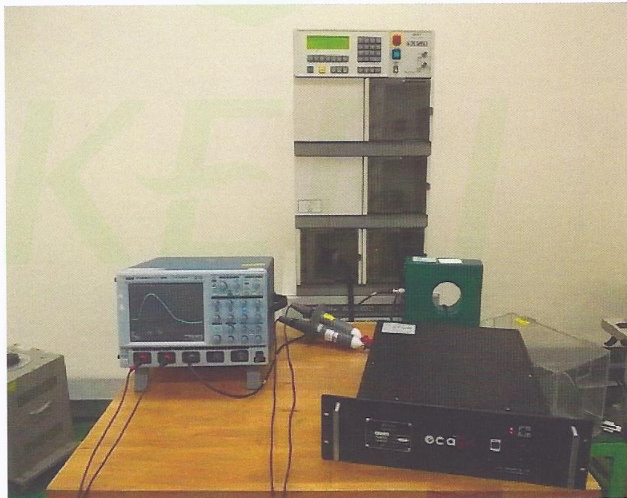
Photo. SG02 : 서지제한전압측정 및 동작책무시험
